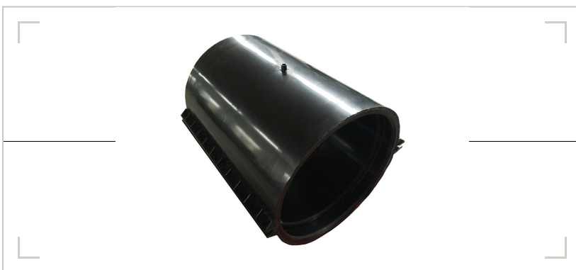
图1 直管哈夫节·碳钢壳体·两半合抱。上下两半壳体合抱破损管段，螺栓紧固后由密封条受压止漏；管道不停水即可作业。
