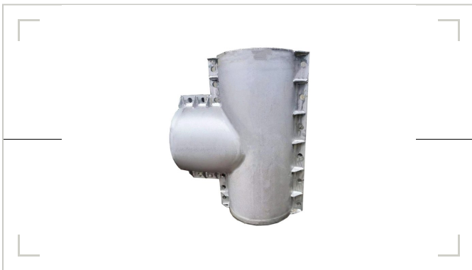
图1 不锈钢三通哈夫节·整件不锈钢·三通壳体。主管开孔接支管处的补强与止漏，整件不锈钢，适合不能补漆的洁净管线。
