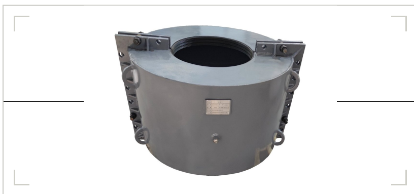
图1 法兰哈夫节·碳钢壳体。法兰接口渗漏的包覆式抢修，不拆法兰即可作业。
