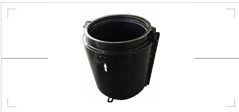
图1 承口哈夫节·碳钢壳体。承插接口处的抢修，壳体包覆承口与插口交界段。
