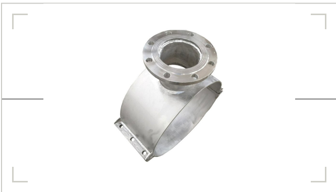
图1 不锈钢法兰哈夫节·整件不锈钢·法兰包覆。法兰接口渗漏的包覆式抢修，不拆法兰即可作业。
