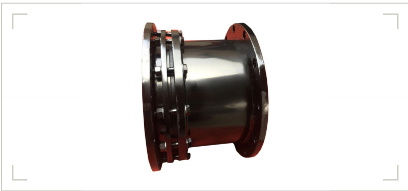
图1 伸缩直接·碳钢壳体。两管端对接，允许轴向伸缩与一定角偏转；拆装无需动管。
