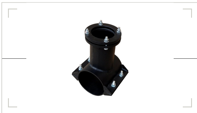
图1 快速接口马鞍三通·碳钢壳体·快速接头支口。支口为快速接头，免焊接、免攻丝。
