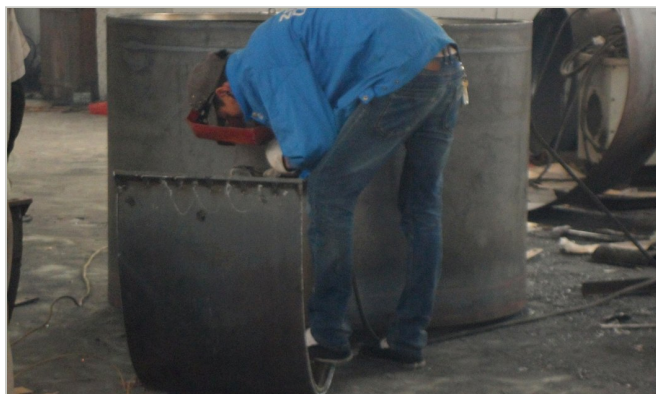
03 车间·焊缝打磨
