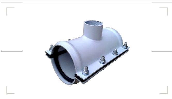
图1 丝口哈夫三通·碳钢壳体·丝口支口。哈夫式三通，壳体合抱主管后引出丝口支管。
