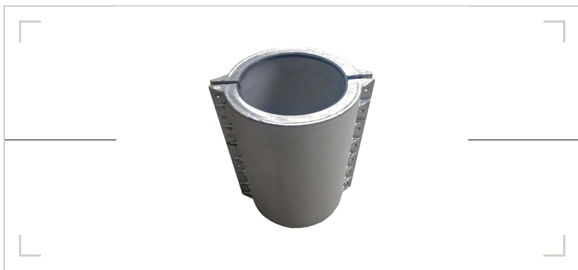
图1 不锈钢直管哈夫节·整件不锈钢·直管壳体。壳体 304 / 316L / 2205 不锈钢，管外壁与介质接触面均为不锈钢；无涂装，不锈钢本色出厂，可按要求抛丸。
