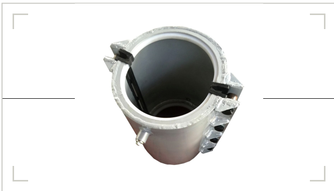
图1 不锈钢耐高温哈夫节·不锈钢壳体·耐高温款。用于热力管、蒸汽管等高温工况，密封配硅橡胶（VMQ），按最高工作温度选型。
