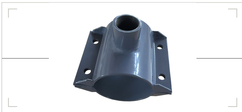
图1 丝口马鞍三通·碳钢壳体·丝口支口。主管上开孔引支管，丝口连接。带压开孔需配专用工具。
