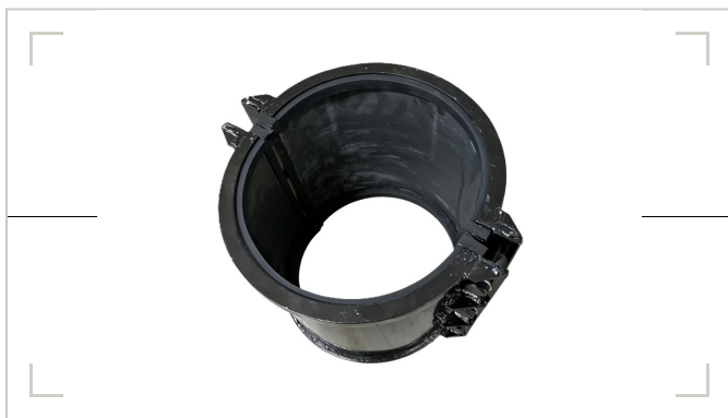
图1 耐酸碱哈夫节·耐酸碱·氟橡胶粘接内壁。用于浓硫酸等强腐蚀介质，氟橡胶（FKM）粘接于壳体内壁。
